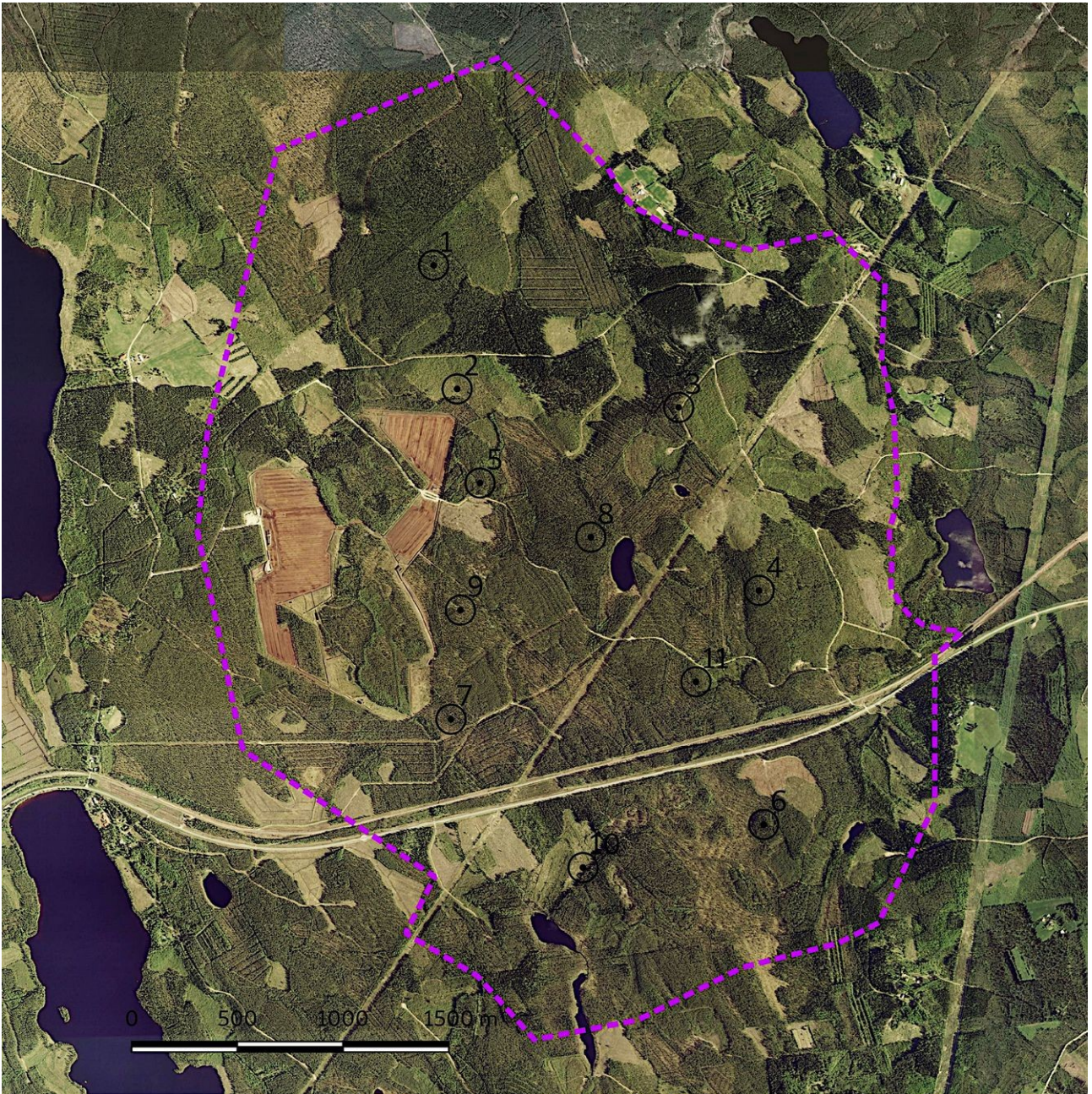
Kartta 4. Ortokuva. Raja violetilla katkoviivalla, voimalat mustana ympyränä; mj-rekisteriin merkitty kohde punaisena pisteenä. Maanmittauslaitoksen ortokuvat 5/2021. >wms-server http://tiles.kartat.kapsi.fi/ortokuva?
