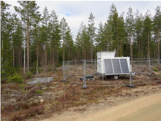
Kuva 9. Voimalapaikka 5 taustalla, tien vieressä tuulenmittauslaite (Doppler-lidar).
