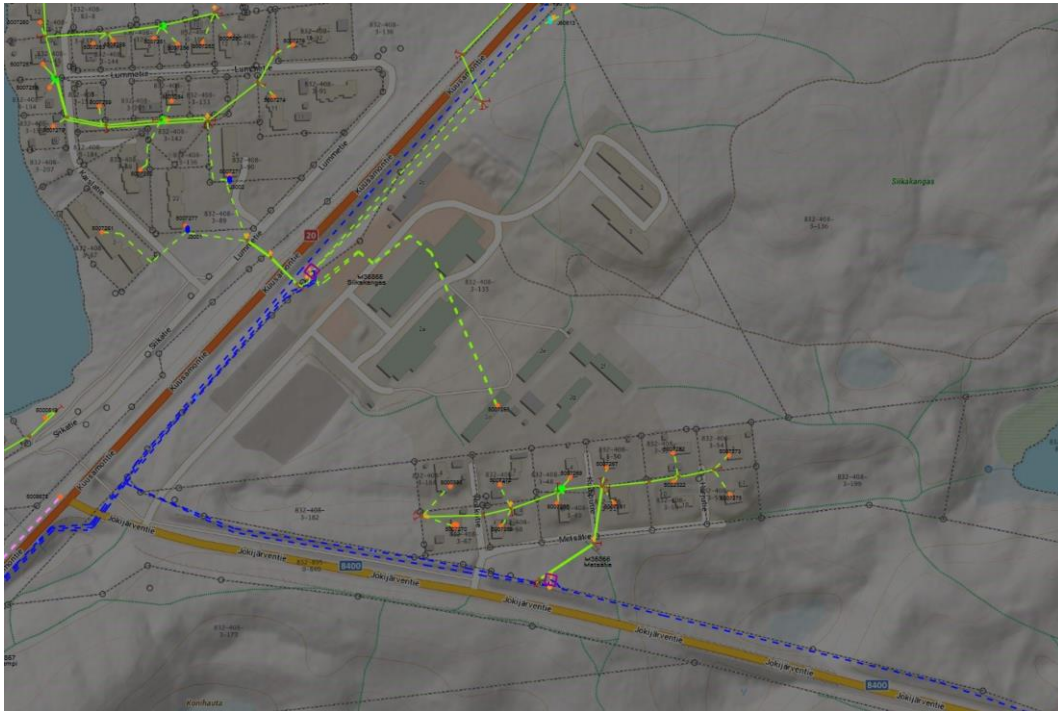
Alueen sähköverkko. Sinisellä viivalla on esitetty 20 kV ja 0,4 kV johdot vihreällä ja vaapeanpunaisilla väreillä. Ilmajohdot on esitetty yhtenäisellä viivalla ja maakaapelit katkoviivalla. (Kartta: Caruna Oy)
